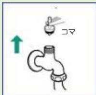
水道本体の中に入っているコマを取り外し、新しいコマと付け替える。ピンセットやラジオペンチを使うと便利。
