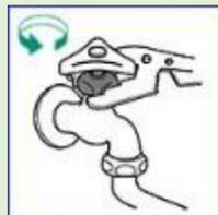
スパナなどの工具を使って、カバーナットを右に回して取り外します。
