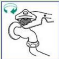
カバーナットを左に閉めて完了。閉めすぎると固くなるので注意。
